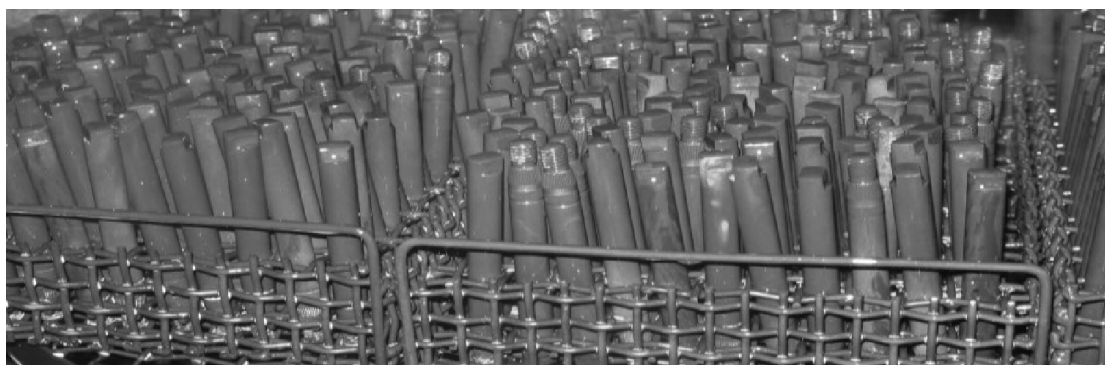
Rysunek 19. Materiał z rdzawym nalotem po procesie azotowania kąpielowego
