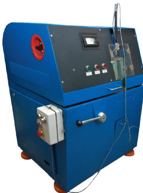
Rysunek 4.10. Widok ogólny zmodyfikowanego młota rotacyjnego typu RSO (fot. autora)
