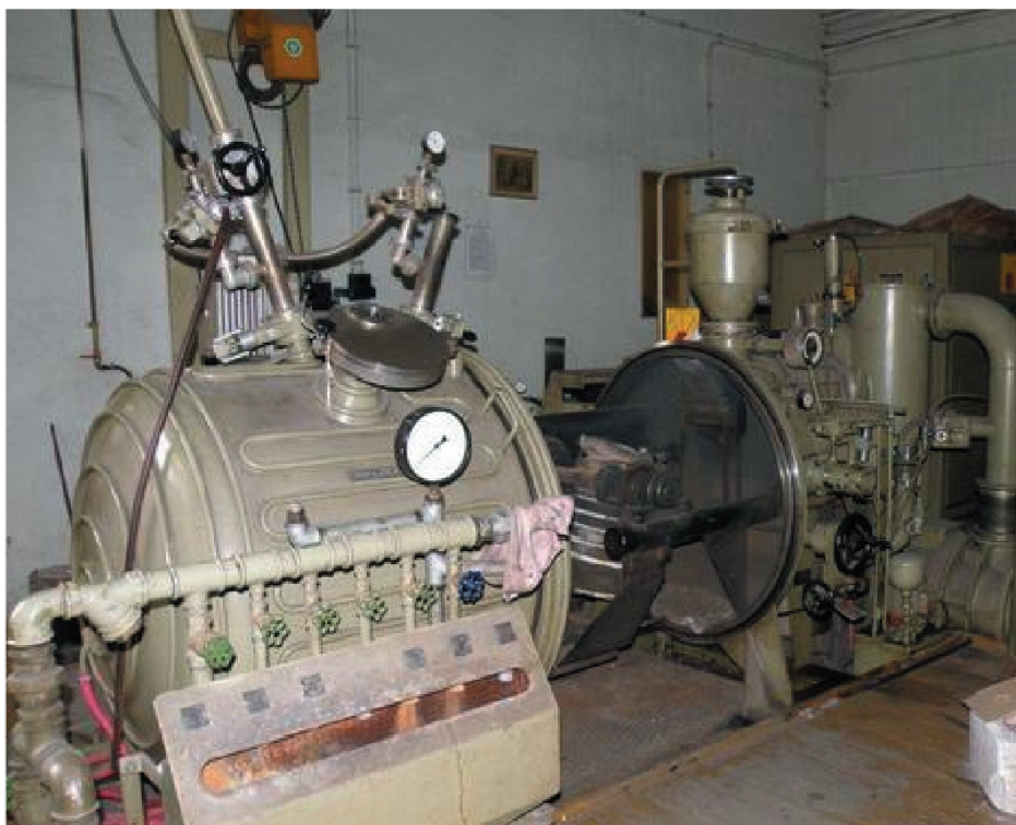
Rysunek 4.1. Schemat pieca laboratoryjnego próżniowego indukcyjnego VSG-50 firmy Balzers (na podstawie materiałów IMŻ Gliwice)
