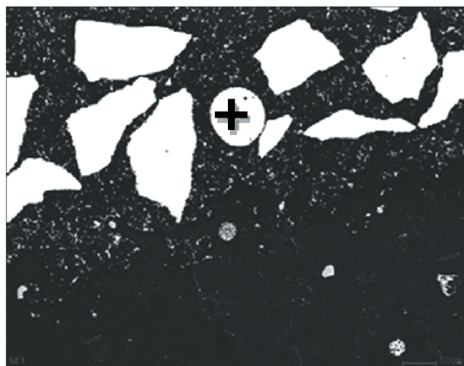
Rysunek 5.38. Przekrój poprzeczny warstwy wierzchniej po wtapieniu proszku WC w powierzchnię odlewniczego stopu aluminium AlSi9Cu, moc lasera 1,5 kW
