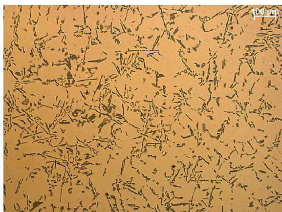
Rysunek 4.10. Mikrostruktura odlewniczego stopu aluminium AlSi9Cu w stanie po starzeniu
