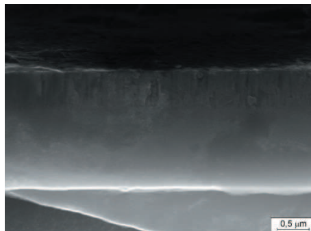
Rysunek 80. Przelom powłoki Cr/CrN/TiN naniesionej na odlewniczy stop magnezu MCMgAl9Zn1
