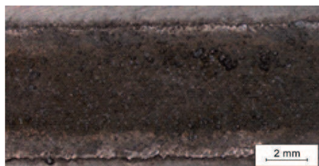
Rysunek 41. Widok lica przetopienia warstwy wierzchniej odlewniczego stopu MCMgAl9Zn1 po wtapianiu proszku SiC, moc lasera 2,2 kW, szybkość wtapiania 0,5 m/min
