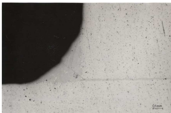
Rysunek 8. Zdjęcie struktury wypływkę lutu z połączenia lutowanego o prawidłowym wklęsłym kształcie (próbka nietrawiona)
