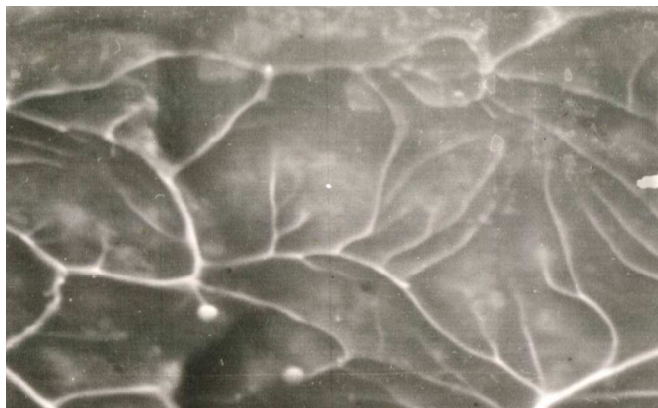
Rysunek 6. Zdjęcie struktury powierzchni przełomu amorficznego stopu \text{Ni}_{89}\text{P}_{11} po dekohezji w teście plastyczności; pow. 3000x
