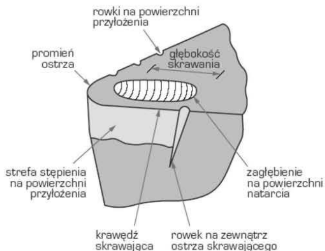
Rysunek 62. Schemat typowego zużycia noża tokarskiego
