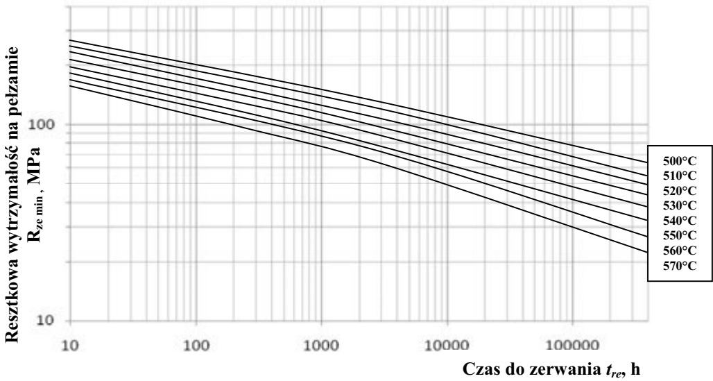
Rysunek 65. Charakterystyki minimalnej resztkowej czasowej wytrzymałości na pełzanie w postaci zależności \log \sigma_b = f(\log t_r) dla różnych poziomów przewidywanej temperatury dalszej eksploatacji niskostopowej stali 13CrMo4-5 po eksploatacji poza obliczeniowy czas pracy o niezapoczątkowanym procesie wewnętrznych uszkodzeń
