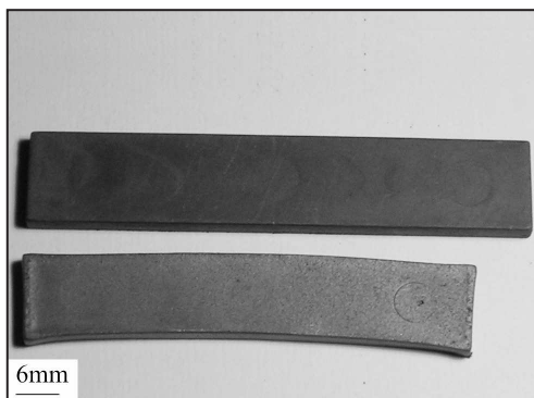
Rys. 6. Widok próbki formowanej wtryskowo (górna) i po usuwaniu lepiszcza oraz spiekaniu (dolna), której skurcz liniowy wynosi około 12%
