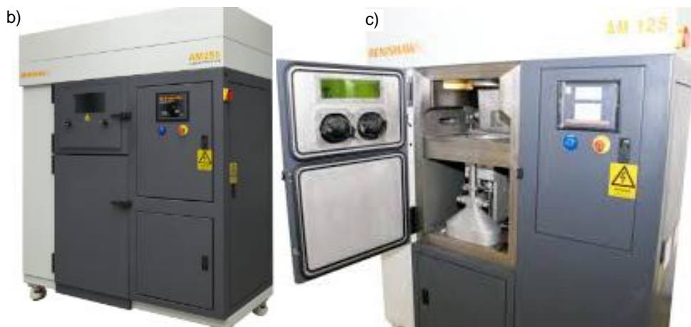
Rysunek 8.15. Urządzenie do selektywnego spiekania laserowego proszków metali AM 125 firmy Renishaw; a) widok ogólny, b) widok komory roboczej
