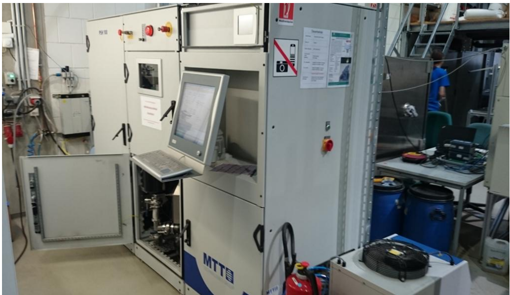
Rysunek 8.14. Widok ogólny urządzenia do selektywnego spiekania laserowego proszków metali SLM 250H firmy MTT Technologies Group
