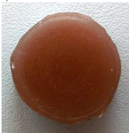
Rysunek 5.11. Próbka przeznaczona do testów trybologicznych: a) przed obróbką mechaniczną, b) po obróbce mechanicznej
