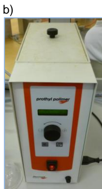
Rysunek 5.10. Polimeryzacja na ciepło: a) schemat procesu, b) polimeryzator ciśnieniowy, c) skafold z naniesioną warstwą akrylu
