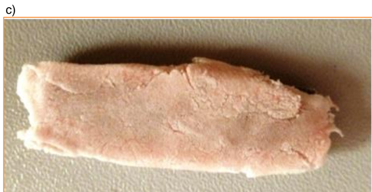
Rysunek 5.10. Polimeryzacja na ciepło: a) schemat procesu, b) polimeryzator ciśnieniowy, c) skafold z naniesioną warstwą akrylu
