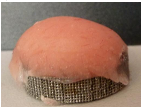
Rysunek 5.11. Próbka przeznaczona do testów trybologicznych: a) przed obróbką mechaniczną, b) po obróbce mechanicznej
