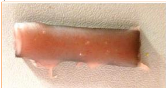
Rysunek 5.9. Polimeryzacja na zimno: a) schemat procesu, b) polimeryzator ciśnieniowy, c) scaffold z naniesioną warstwą akrylu
