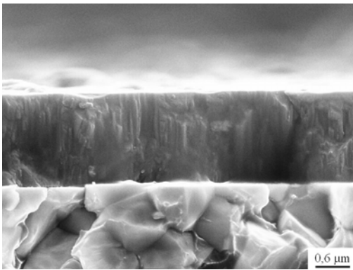
Rysunek 4.12. Powierzchnia przelomu powłoki (Ti,Zr)N naniesionej na węglkach spiekanych [87]
