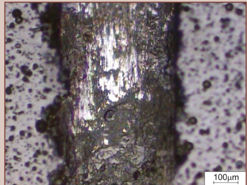
Rys. 6. Ślad zarysowania powierzchni powłoki Ti/Ti(C,N)/CrN osadzonej na podłożu z odlewniczego stopu magnezu MCMgAl9Zn1 węglnikiem diamentowym w metodzie scratch test przy obciążeniu krytycznym L_{C2}
