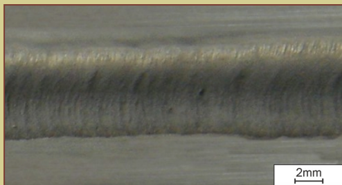
Rys. 1. Widok lica przetopienia warstwy wierzchniej odlewniczego stopu magnezu MCMgAl3Zn1 po wtapieniu proszku WC; moc lasera 1,2 kW, prędkość wtapienia 0,75 m/min
