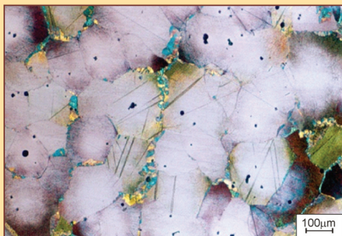
Rys. 3. Struktura odlewniczego stopu magnezu MCMgAl19Zn1; obserwacja w świetle spolaryzowanym
