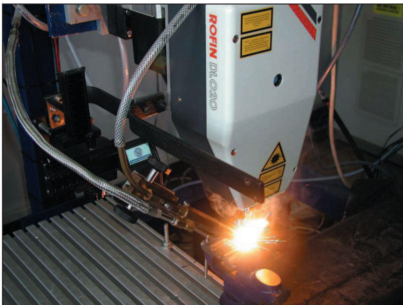
Rysunek 45. Laser diodowy dużej mocy HPDL ROFIN DL 020 w czasie pracy użyty do powierzchniowej obróbki laserowej badanych stali [92]
