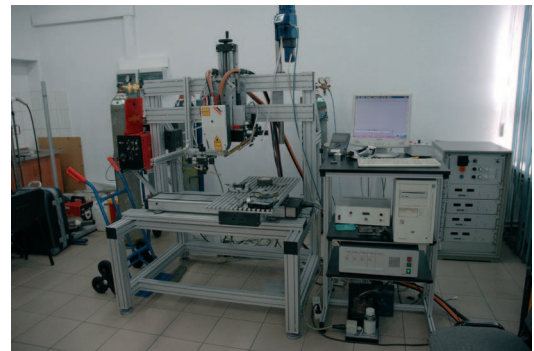
Widok stanowiska wykorzystanego podczas stopowania laserowego stali proszkami węglików.
